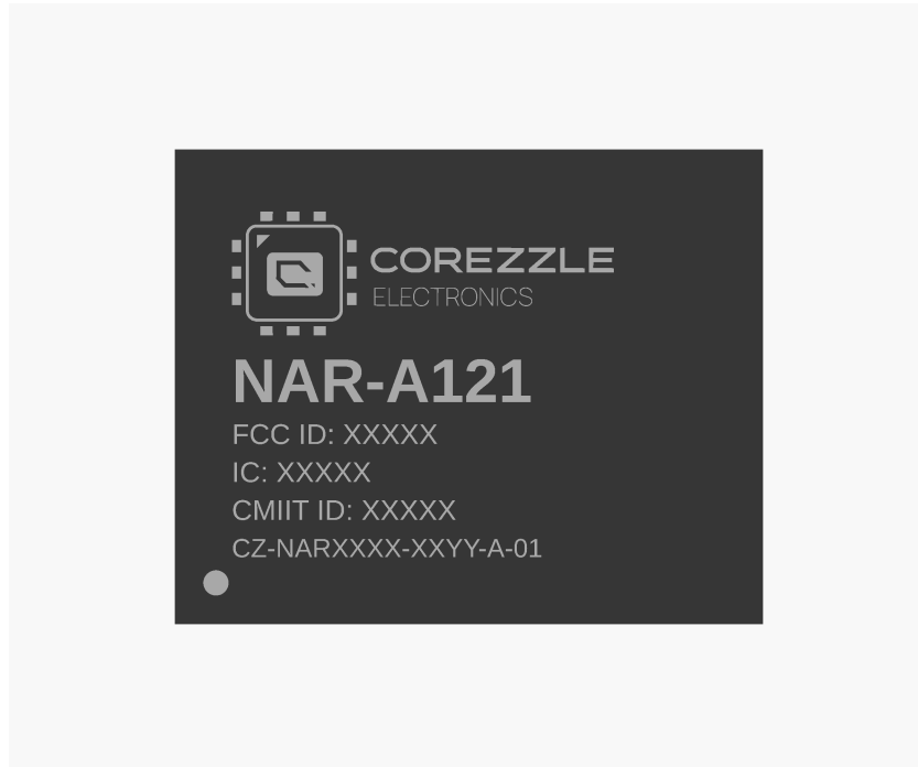
Şekil 9.4. NAR-A121 üst yüz işaretlemesi. Pin 1 işareti sol alt köşededir (bkz. Şekil 3.1). Sertifika alanları belge numaraları alınana kadar yer tutucudur.
